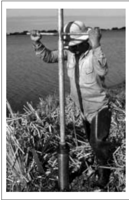
Figura 5. Extracción de muestras en un perfil vertical de embalsados (Histosol). El aparato fue diseñado especialmente para estos suelos, a partir de un sistema-válvula utilizado en las perforaciones para extraer agua con molino de viento. Por dentro lleva una camisa (caño de PVC) partido longitudinalmente, como se muestra en la Figura 9
